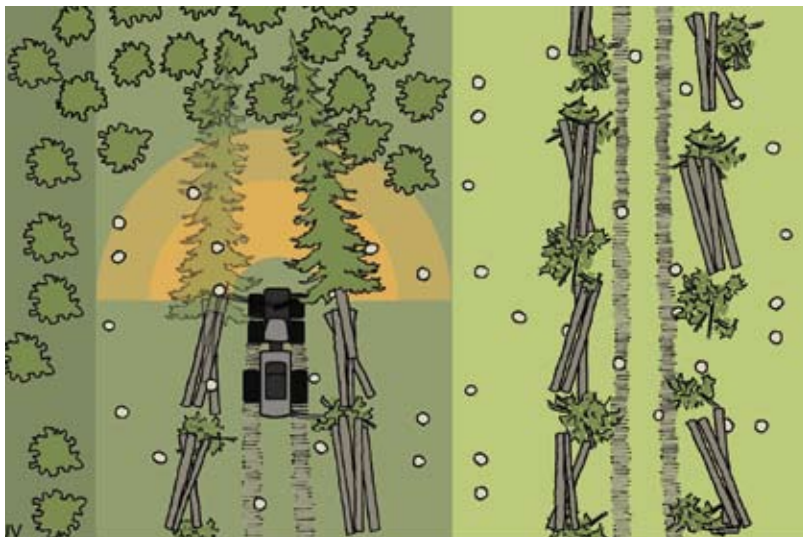
Kuva 12. Eteenpäinkaatomenetelmä soveltuu kohteeseen, jossa puutaran laatu vaihtelee tai hakkuutähteet kerätään energiakäyttöön.
